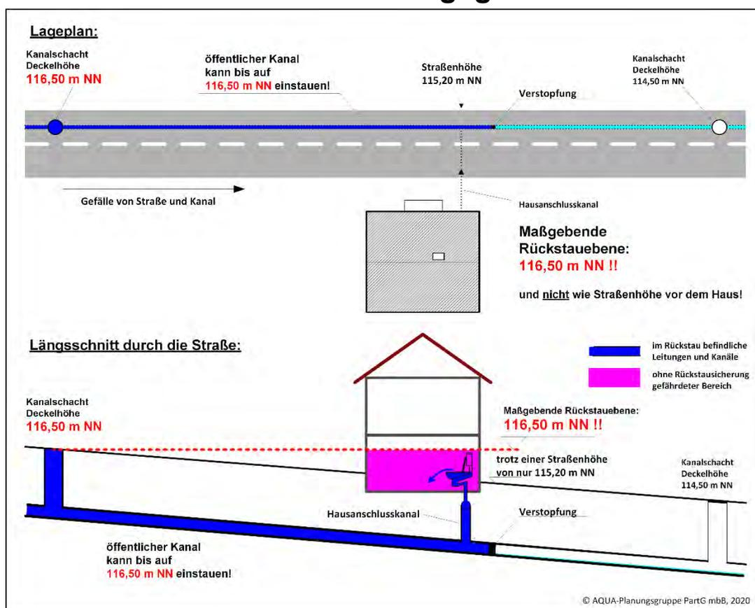
In diesem Beispiel wird die Höhe der Rückstauenebene durch die Höhe des bergauf liegenden Kanalschachtes definiert, d.h. dies ist die erste Stelle, an der das Wasser aus dem Kanalnetz auf die Geländeoberfläche austreten kann. Die maßgebende Höhe kann aber auch durch einen an den Kanal angeschlossenen Straßeneinlauf definiert werden, wenn dieser zwischen Anschlussstelle und dem oberhalb liegendem Schacht liegt.
