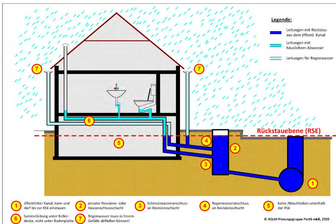
Für Gebäude ohne Keller stellt diese Situation in den meisten Fällen den Normalfall dar. Ein Rückstauschutz wird bei diesen Gebäuden erst dann erforderlich, wenn der Erdgeschossfußboden unterhalb der Rückstaebene liegt.
