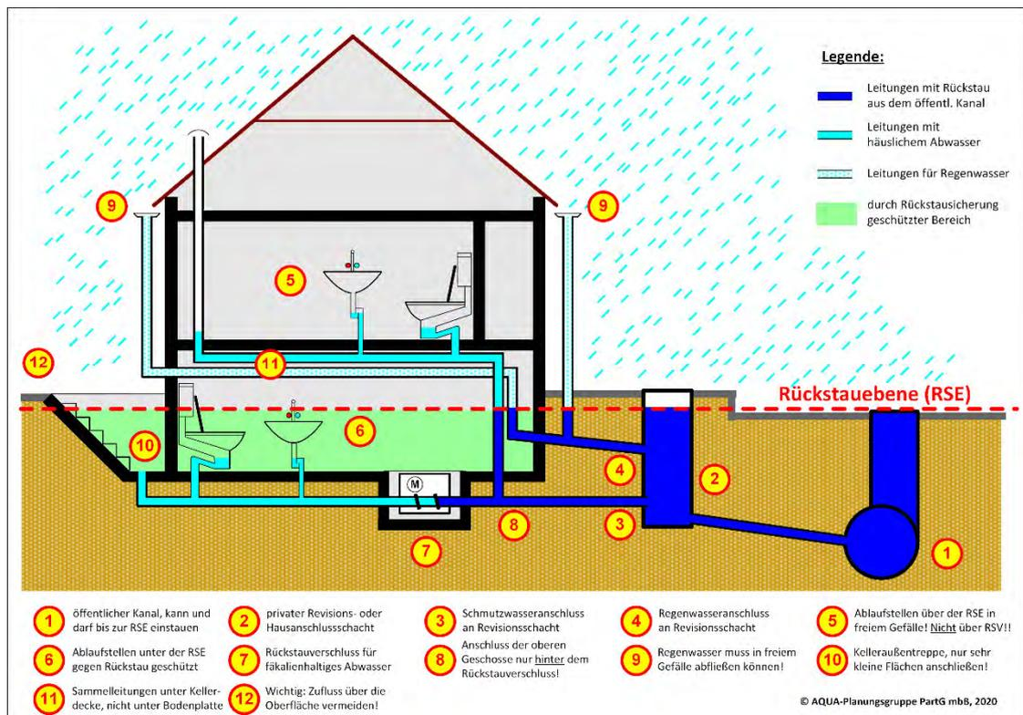
Besser ist der Einbau nur einer automatisch schließenden Sicherung an der Stelle, wo die Grundleitung das Haus verlässt.
